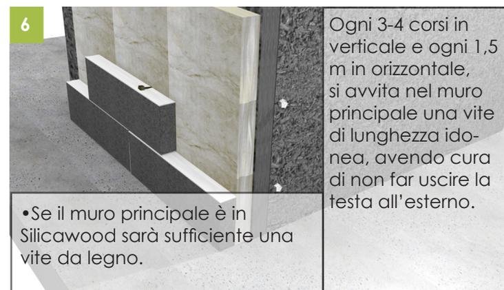
Ogni 3-4 corsi in verticale e ogni 1,5 m in orizzontale, si avvita nel muro principale una vite di lunghezza idonea, avendo cura di non far uscire la testa all'esterno.
