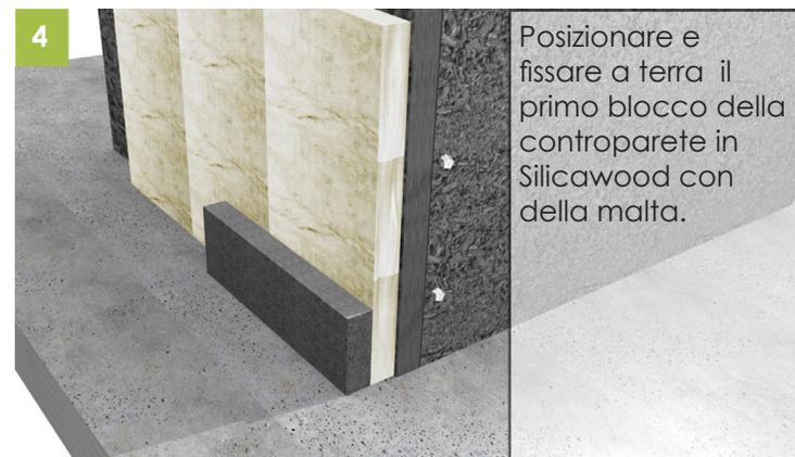
Posizionare e fissare a terra il primo blocco della controparete in Silicawood con della malta.
