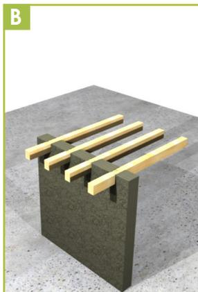
**B** Se si ha la presenza di un balcone, le travi sporgono per la lunghezza di quest'ultimo verso l'esterno della casa. Se non vi è il balcone le travi vengono interrotte all'interno della parete per una lunghezza utile al solo appoggio delle stesse.
